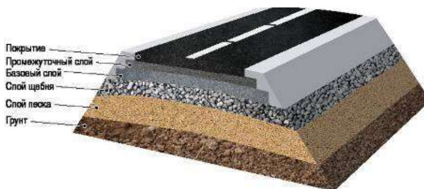
Рисунок 2. Конструкция дорожной одежды
