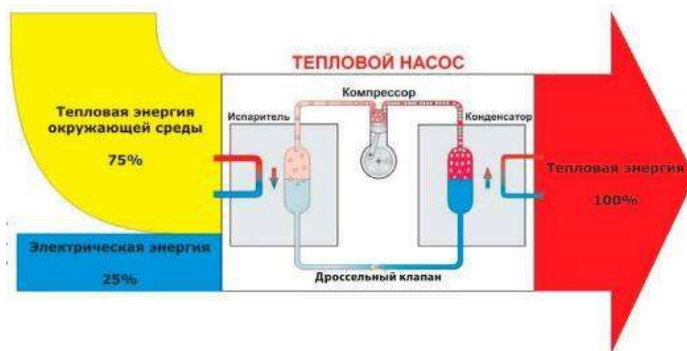
Рисунок 2. Принцип работы теплового насоса
