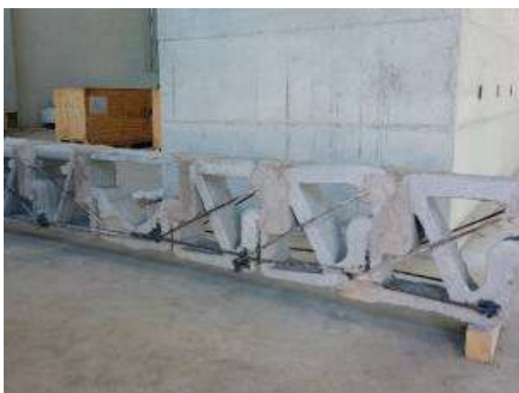
Рисунок 3. Первая напечатанная на 3D-принтере модульная железобетонная балка длиной около 3 м.
