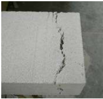
Фото 1. Трещины, возникшие из-за несоответствия скоростей роста объема массива и его твердения
